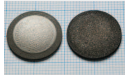
Die Helmholtz-Allianz MEM-BRAIN entwickelt Membranen zur Abscheidung von Kohlendioxid. Forschungszentrum Jülich
