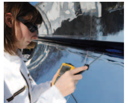
Freiluft-Prüfstand: Messung an einem Absorberrohr. Deutsches Zentrum für Luft- und Raumfahrt
